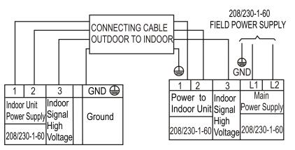
Fig. 9 — Connection Diagram 24K-36K (208/230-1-60 V)
